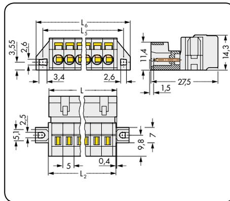
$L = (\text{кол-во полюсов} - 1) \times \text{шаг контактов} + 8,2 \text{ мм}$
