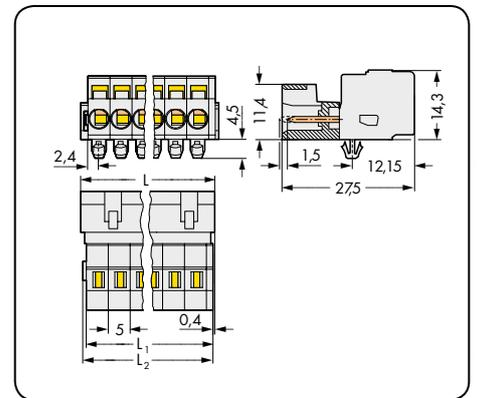
$L = (\text{кол-во полюсов} - 1) \times \text{шаг контактов} + 8,2 \text{ мм}$
