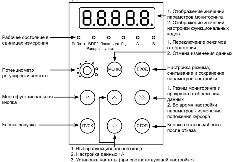
Рисунок 5 – Описание съемной панели управления VCI-KP
