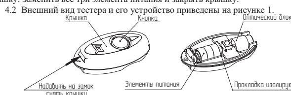
Рисунок 1 – Внешний вид тестера и его устройство
