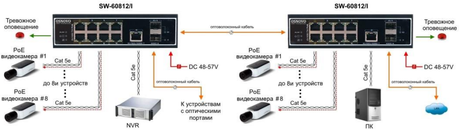
Рис.5 Схема каскадного подключения коммутатора SW-60812/I
