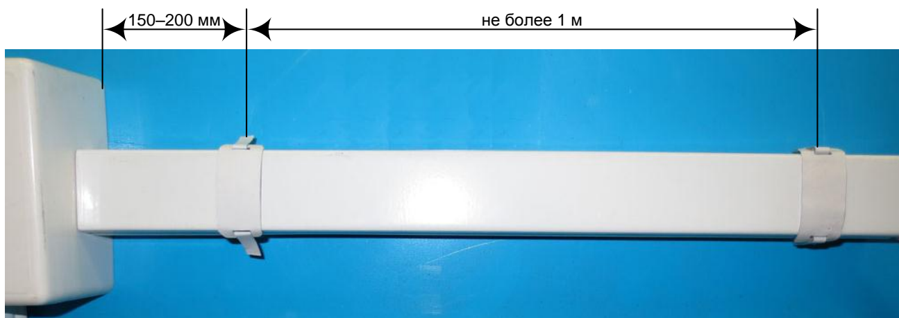
Рис. 21. Фиксация верхней крышки.
