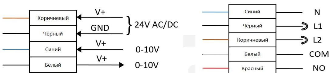
Для 3-точечных приводов присоединитесь к проводам согласно схеме. Вращение привода достигается путем подачи управляющего напряжения 24 или 220В на один из проводов (черный или коричневый), синий провод «нейтраль» от сети или понижающего трансформатора. По белому и красному проводам посыпается обратная связь с концевого выключателя, встроенного в привод.
