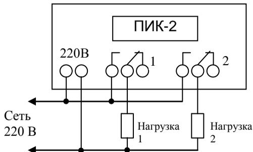
4.1.6. Подайте питание на реле. Для предварительной зарядки аккумулятора оставьте реле включенным в сеть на время не менее 8 час.
