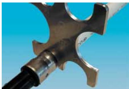
2. Повернуть инструмент на 360° вокруг требуемого сечения и обеспечить идеальное совмещение во время этого шага, как и на шаге 4. Если это не так (например, если расстояние между ними слишком велико или имеется препятствие), то что-то неправильно в обжиме в соединении. В этом случае мы рекомендуем вам выполнить совершенно новое пресс-соединение и проверить обжимное устройство, используя губки обжимного инструмента.
