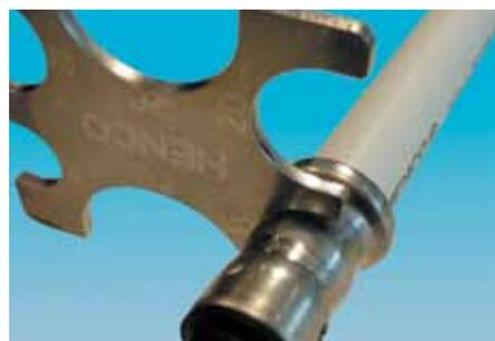
*ПРИМЕЧАНИЕ. Измерительный шаблон PRESSCHECK подходит только для обжимных соединений, производимых с профилем Henco (профиль BE) или профилем TH (диаметром до 26 мм) в сочетании с пресс-фитингом Henco из PVDF или латуни.*
