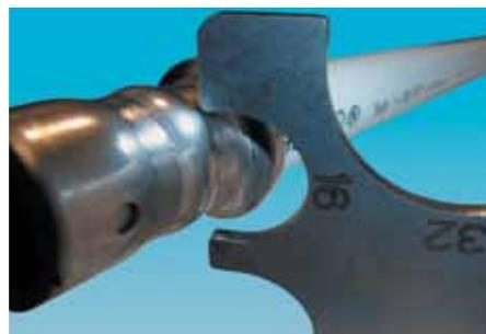
3. Ввести узкую часть обжимаемой втулки в соответствующий вырез измерительного шаблона.
