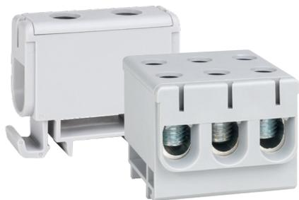
Клеммы вводные силовые серии OptiClip КВС используются в качестве вводных и распределительных клемм при сборке НКУ. Основное назначение – элемент переходного соединения алюминиевых и медных проводов со специальной подготовкой от 6 до 95 мм<sup>2</sup>, а также в качестве дополнительного элемента для подключения и установки промышленного оборудования в цепях переменного или постоянного тока до 800 В.
