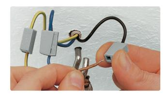
Монтажные клеммы без пасты Navigator серии NTC-NC предназначены для безопасного соединения одножильных и многожильных медных проводников с втулочными наконечникамигильзами в электрических цепях переменного тока с частотой 50/60 Гц и напряжением до 450 В.
