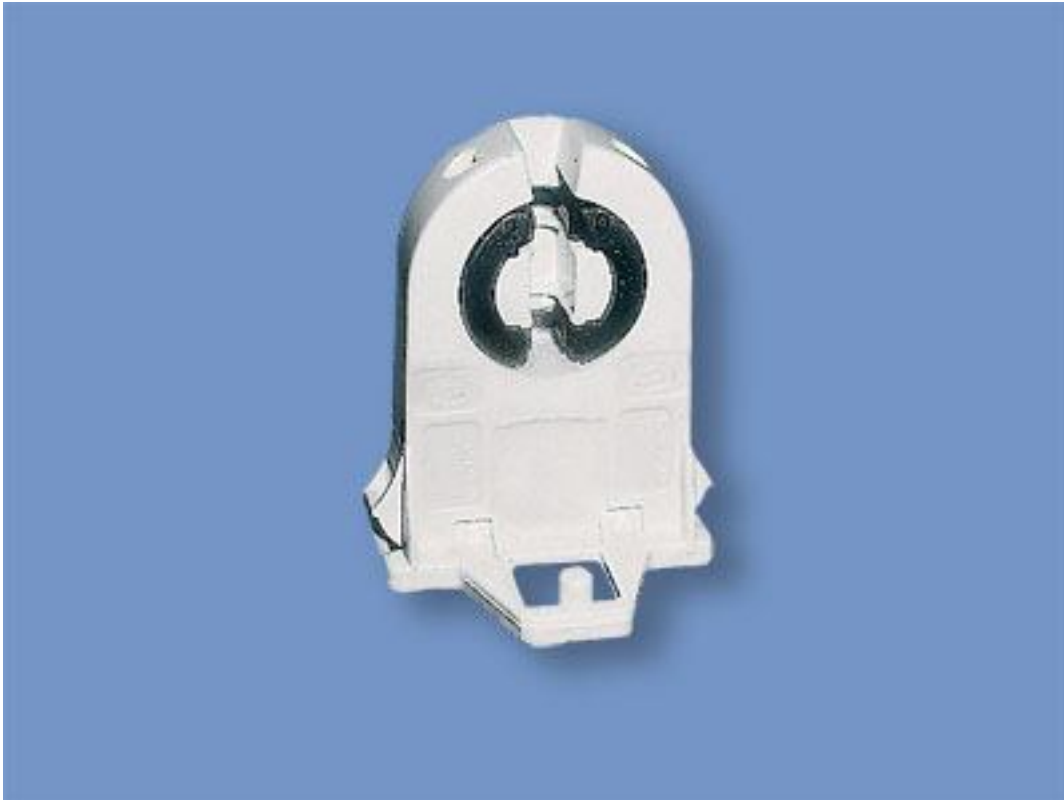
Патрон (ламподержатель) G13 для сквозного крепления с тыльной стороны, h- оси 23mm, со стопором, для T8, T12 люминесцентных ламп (крепление на боковые защелки)
