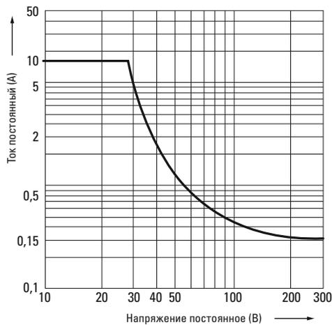
Зависимость коммутационной способности от коммутируемого напряжения.
