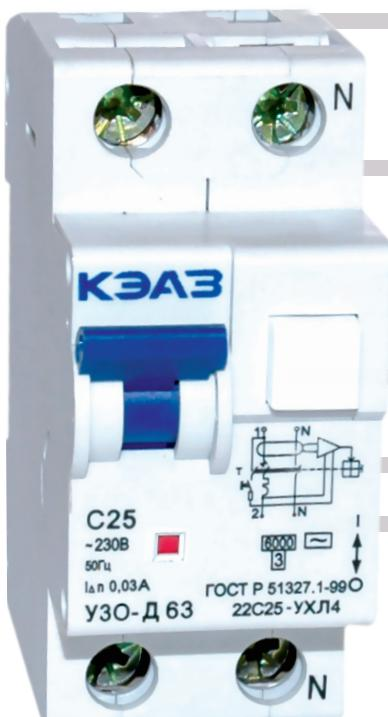
УЗО-Д63 – электронно-механическое устройство, функционально зависящее от напряжения сети (не размыкающееся автоматически в случае исчезновения напряжения). УЗО-Д63 сохраняет работоспособность при пониженном напряжении сети (до 50 В).
