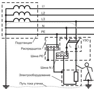
В системе с глухозаземленной нейтралью TN-S электроэнергия от подстанции к потребителю подается с помощью пятипроводного кабеля. В этой системе рабочий (N) и защитный (PE) нейтральные проводники разделены еще на подстанции.
