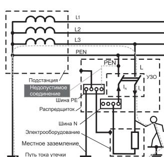
В системе с глухо-заземленной нейтралью TT, которая применяется в мобильных зданиях и сооружениях, а также в зданиях с металлическими каркасами, когда электроэнергия от подстанции к потребителю подается с помощью четырехпроводной воздушной линии.
