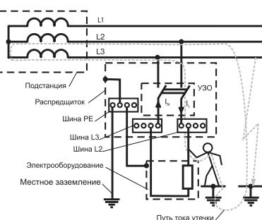
В системе с изолированной нейтралью IT, которая применяется в помещениях с повышенной опасностью, а также в особо опасных помещениях, электроэнергия от подстанции к потребителю подается с помощью трехпроводного кабеля.
