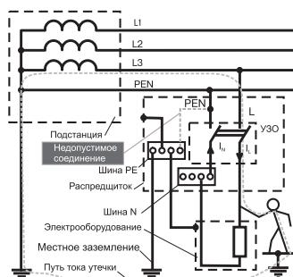
В системе с глухо-заземленной нейтралью TN-C-S электроэнергия от подстанции к потребителю подается с помощью четырехпроводного кабеля - три фазных проводника и один нейтральный (PEN) проводник, объединяющий функции рабочего и защитного нейтрального проводников,
