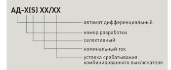
Дифференциальный автоматический выключатель представляет собой аппарат, сочетающий функции автоматического выключателя с устройством защитного отключения. При обнаружении автоматическим выключателем в защищаемом участке сети тока утечки (повреждения) на землю или сверхтока (тока перегрузки или короткого замыкания) происходит срабатывание устройства, приводящее к отключению защищаемой сети.
