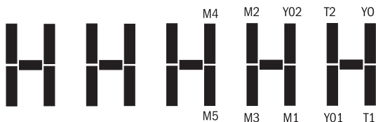
Рисунок 47 – Монитор состояния промежуточных реле
