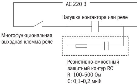
Рисунок 16 – Подключение выходного реле на переменный ток
