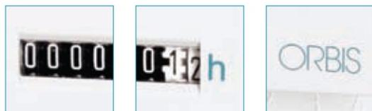
Счетчик моточасов CONTA modular (модульный) подключается к цепи питания контролируемого прибора, при подаче питания на прибор - подается питание одновременно и на счетчик, при отключении питания - отключается и счетчик, счет прекращается. При каждой подаче питания счет продолжается нарастающим итогом.
