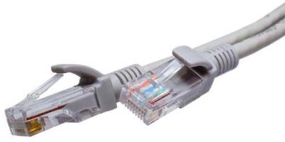
Патч-корд (Patch-cord) – отрезок многожильного Lan-кабеля (7х0,16мм), оконеченный с обоих концов коннекторами типа 8P8C (RJ45).
