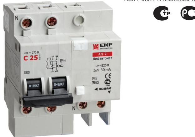
Дифференциальный автоматический выключатель представляет собой аппарат, сочетающий функции автоматического выключателя с устройством защитного отключения. При обнаружении автоматическим выключателем в защищаемом участке сети тока утечки (повреждения) на землю или сверхтока (тока перегрузки или короткого замыкания) происходит срабатывание устройства, приводящее к отключению защищаемой сети.
